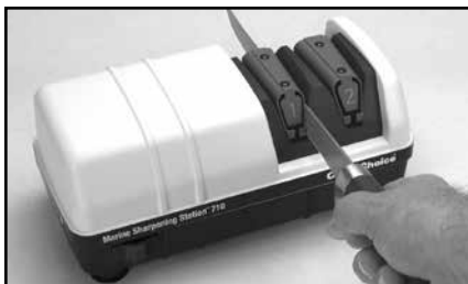
Afbeelding 4. Invoegen lemmet in rechtersleuf van fase 1.
