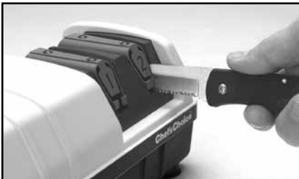
Afbeelding 9. Slijp gekartelde messen alleen in fase 2 (zie instructies).
