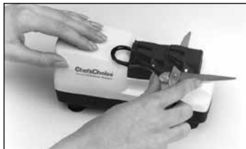
Figure 6. Position recommandée pour affûter les ciseaux pour droitiers.
