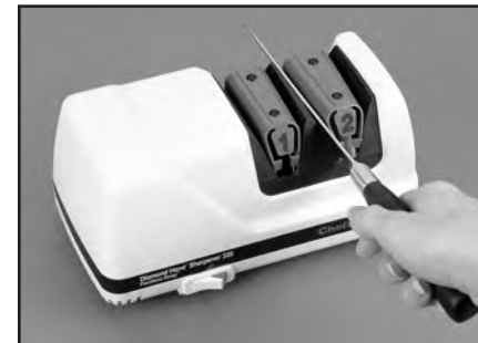
Afbeelding 6. Invoer van de snede in de linkersleuf van fase 2 in afwisselend de linker- en de rechtersleuf.
