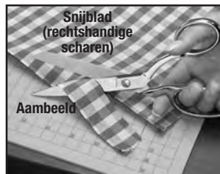
Afbeelding 2. Doorsnee positie van het snijblad en het aambeeld
