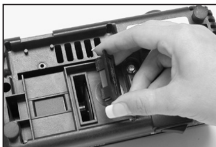
Afbeelding 11. Afscherming onder de basis verwijderen om metaalstof te verwijderen.
