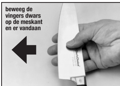
Afbeelding 5: De braam is voelbaar wanneer men de vingers dwars op en van de snede vandaan schuift. Let op! Zie tekst.
